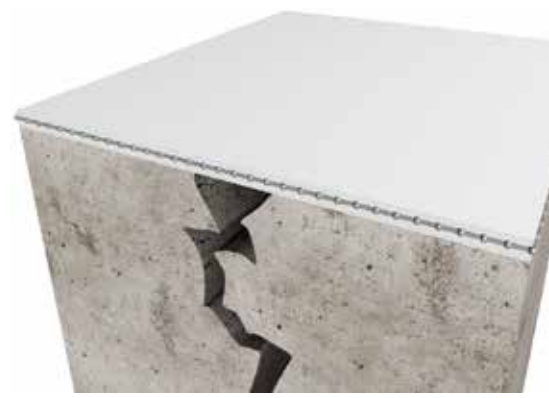
4. KÖSTER Flex Fabric втапливается в первый слой
