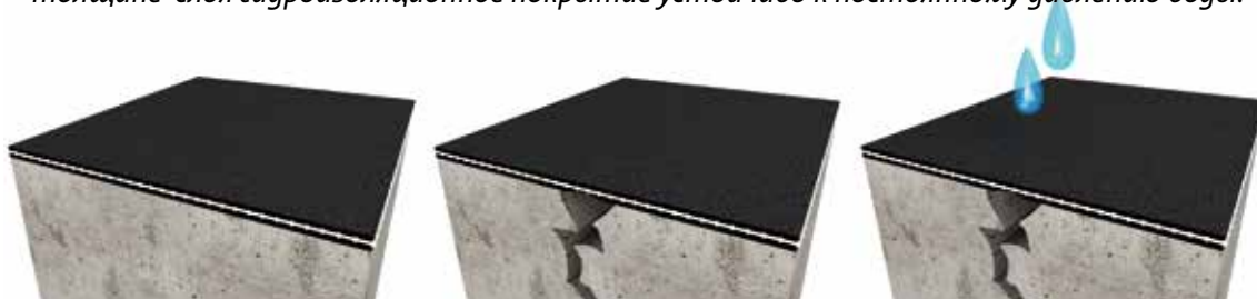
3. Перекрытие трещин благодаря уложенной сетке. Сетка отделяет верхний гидроизоляционный слой от трещины и делает покрытие значительно устойчивей к постоянному давлению воды.
